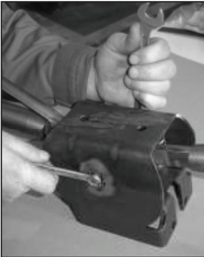
2. Remove the nut on the central bolt.
