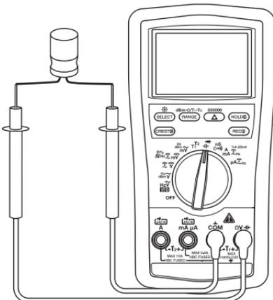
*Hinweis: Bei polarisierten Kondensatoren die rote Sonde an den positiven Anschluss und die schwarze Sonde an den negativen Anschluss des Kondensators anschließen.*
