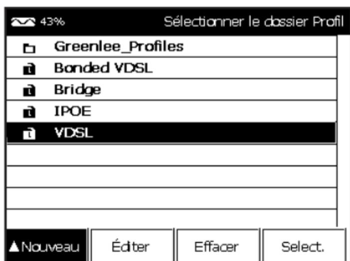
3. Les trois différentes icônes à gauche de la ligne indiquent s'il s'agit d'un dossier, d'un profil verrouillé ou d'un profil déverrouillé. Seuls les profils déverrouillés peuvent être modifiés avec l'appareil de test. L'application du bureau « Greenlee Records Manager » peut être utilisée pour verrouiller ou déverrouiller les profils. Tout appareil de test neuf contient un profil « personnalisé » que l'utilisateur peut modifier.
