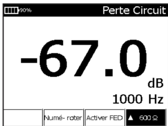
3. Activer le signal d'essai en composant depuis un combiné externe ou à l'aide du menu de composition interne de l'appareil de test Sidekick® Plus.
