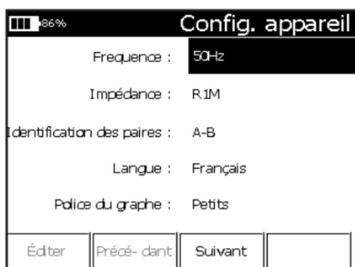
Le premier écran de configuration de l'appareil (Config. appareil) propose les options suivantes. Chaque option est accessible à l'aide des touches flèche vers le haut (2) ou flèche vers le bas (8) :
