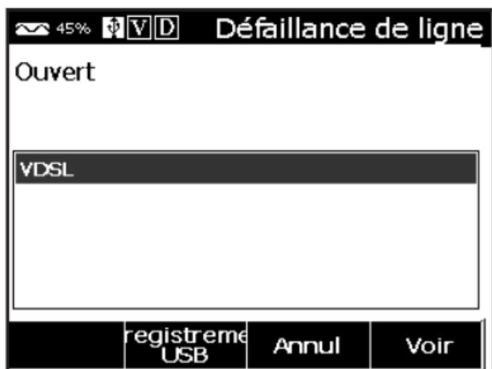
4. Appuyer sur **F2 Enregistrement USB** pour enregistrer les résultats du contrôle au format XML sur la clé USB.
