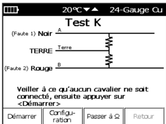
Contrairement à la méthode d'essai RFL qui utilise deux câbles non défectueux raccordés avec un cavalier, on démarre le test K *sans* cavalier relié à l'extrémité.
