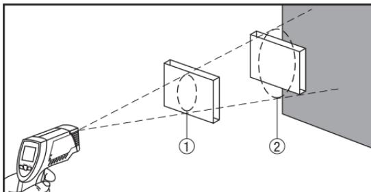
L'objet 1 se trouve à la bonne distance de l'appareil. On notera que la cible est légèrement plus grande que la tache de mesure.
