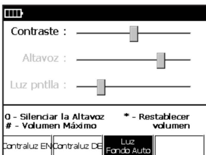
Oprima **F1 Contraluz EN** para deshabilitar el temporizador de apagado automático. Oprima **F2 Contraluz DE** para desactivar la contraluz. Oprima **F3 Contraluz Auto** para habilitar el temporizador de apagado automático de 5 segundos. Mientras esté habilitado el temporizador, se encenderá la contraluz cada vez que se oprima una tecla o se gire el botón. La contraluz se apagará entonces después de 5 segundos (el tiempo se puede ajustar en los parámetros de configuración).
