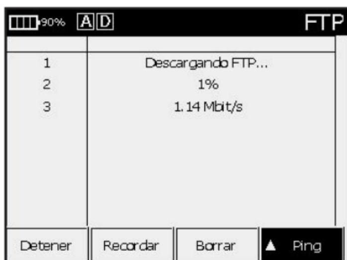
La prueba de FTP se inicia automáticamente con la última dirección IP utilizada o con el valor predeterminado de fábrica. Para ingresar una dirección IP nueva para FTP, presione **F3 Dirección IP**. Ingrese la dirección IP del destino que desea descargar. Cuando haya terminado, presione la tecla **# (Entrar)** y la unidad iniciará automáticamente la prueba de FTP.
