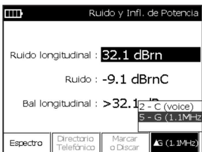
El filtro “C (voz)” es un filtro de mensaje C para banda de voz 300 Hz a 3 kHz.
