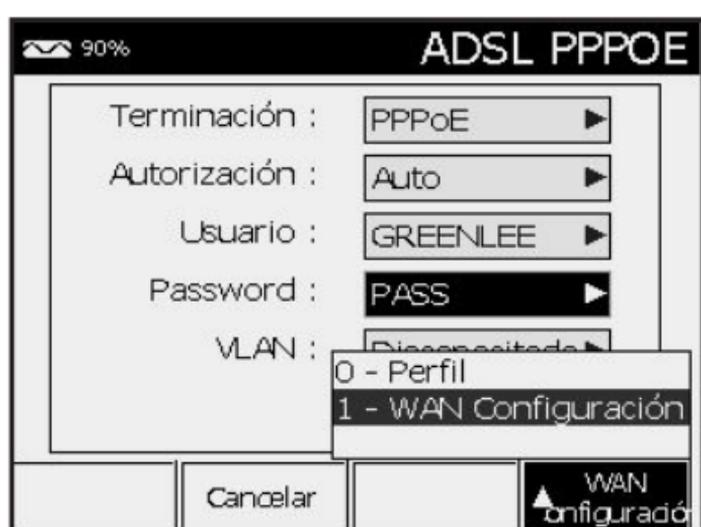
Utilice las flechas hacia arriba (**2**) y hacia abajo (**8**) para seleccionar el parámetro de configuración que se desea cambiar. Para realizar un cambio, presione la tecla derecha (**6**) para mostrar la ventana emergente de selección.
