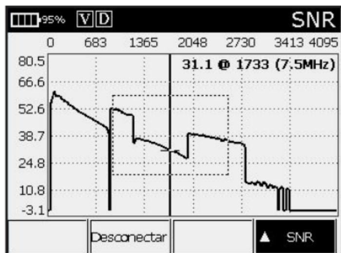
El gráfico de SNR muestra la relación señal-ruido de cada canal (frecuencia). Puede indicar problemas típicos de ruido de la línea, como diafonía. El eje horizontal es el índice de ubicación y el eje vertical representa la SNR en dB.
