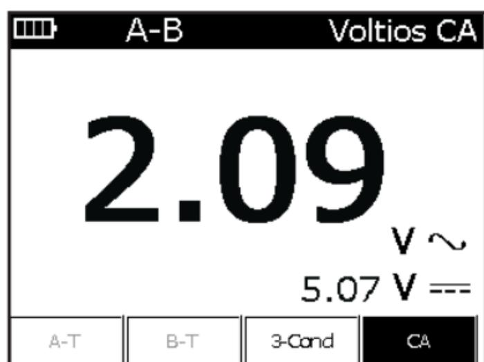
La pantalla LCD indica el voltaje CA presente en un par único de A a B. En la esquina superior izquierda aparece "A-B".
