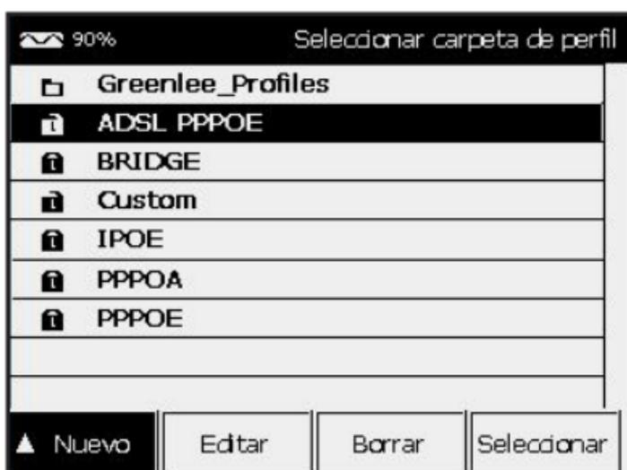
3. Los tres iconos diferentes del costado izquierdo de la fila indican si la línea es una carpeta, un perfil bloqueado o un perfil no bloqueado. Únicamente los perfiles no bloqueados se pueden modificar con el equipo de pruebas. Para bloquear o desbloquear perfiles se puede utilizar la aplicación de escritorio “Greenlee Records Manager”. Un equipo de pruebas nuevo incluirá un perfil “Custom” (Personalizado) mismo que el usuario puede modificar.
