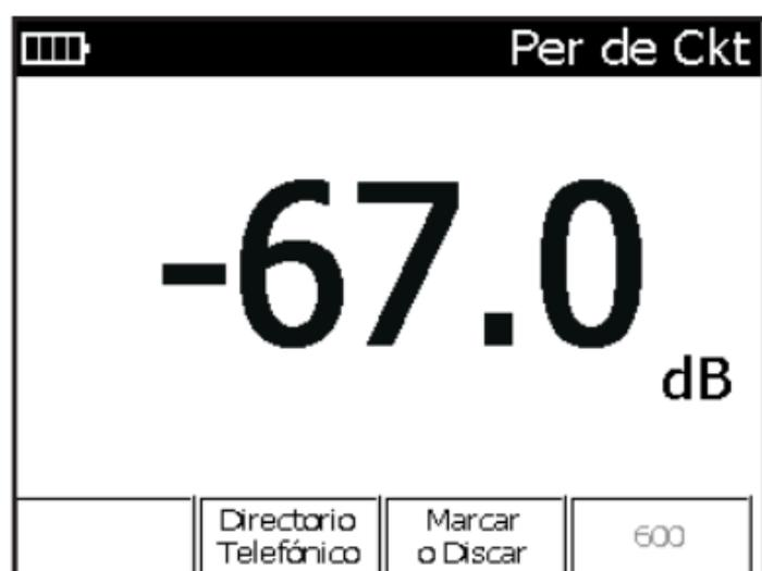
3. Active la señal de prueba marcando desde un microteléfono de cabeza externo o mediante el menú de discado interno del equipo de pruebas Sidekick® Plus.
