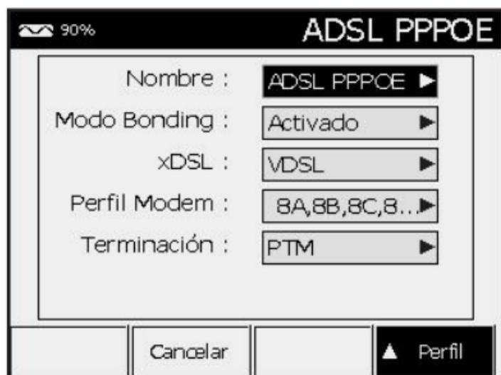
6. Use las flechas hacia arriba (2) y hacia abajo (8) para seleccionar el parámetro de módem que se desea cambiar. Presione la tecla derecha (6) para cambiar el parámetro seleccionado.
