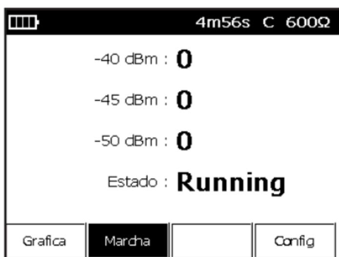
La pantalla muestra umbrales de  $-40$  dBm,  $-45$  dBm y  $-50$  dBm establecidos, y prueba en ejecución (“Running”). Hay disponibles tres teclas de función:
