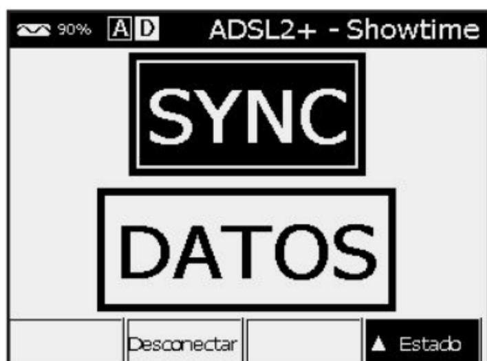
La primera página de resultados es la página "Estado". Esta página se utiliza para indicar el estado de la sincronización de capa física (SYNC) y la autenticación de capa superior (DATOS). Si la sección WAN de la configuración contiene la información de autenticación correcta, el módem se autenticará en la línea después de que se realice la sincronización.
