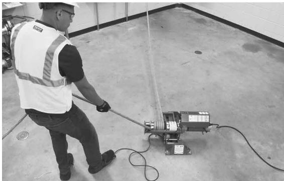
**Figure 31 : Position d'utilisation adéquate de la fixation au sol**
