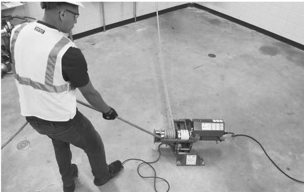
**Figura 31: Posición de funcionamiento adecuada del montaje para piso**
