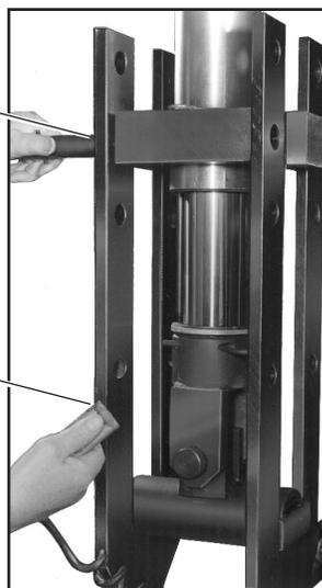
Clavija de la culata del cilindro
