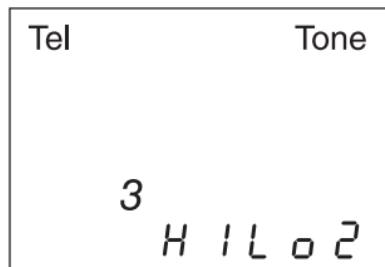
In dieser Anzeige erzeugt nur Draht „3“ des Telefonkabels den „HiLo2“-Ton.
