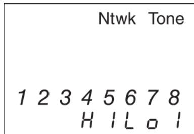
Por ejemplo, esta pantalla muestra que todos los alambres de un cable de red conducen el tono "HiLo1".
