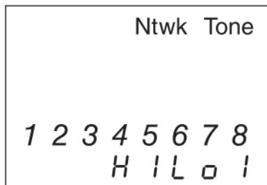
Diese Anzeige zeigt z. B., dass alle Drähte eines Networkkabels den „HiLo1“-Ton erzeugen.
