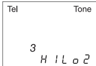
En esta pantalla, sólo el alambre "3" del cable de teléfono conduce el tono "HiLo2".
