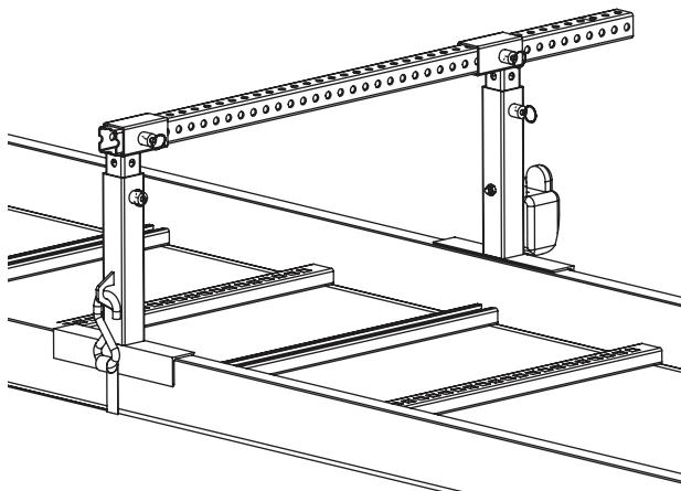
5. **Uniquement pour la CTF-200EXT :** ajustez la hauteur de la traverse (2) au moyen des goupilles (1) des montants inférieurs du dispositif de montage.
