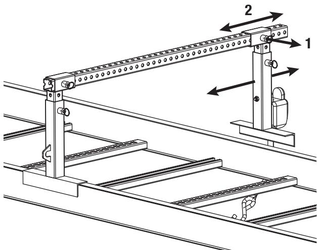
5. Solo para CTF-200EXT: Ajuste la altura de la barra transversal (2) por medio de los pasadores (1) de las patas de fijación inferiores.
