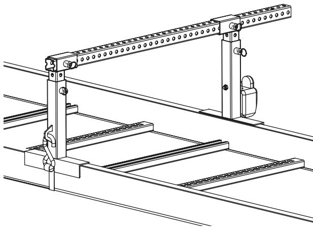
1. Coloque una sola pata del soporte en un lado de la bandeja.
