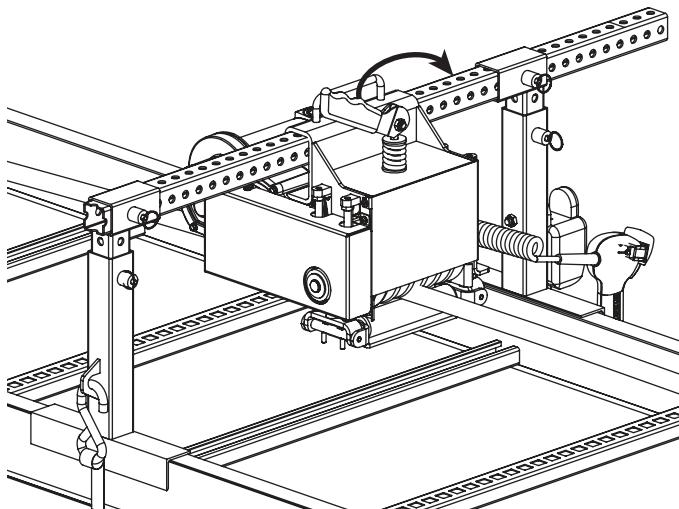
4. Activez la ligne d'alimentation en appuyant en continu sur l'interrupteur à bascule du tirant. En commençant par la vitesse la plus basse, augmentez la vitesse jusqu'à ce qu'elle atteigne la vitesse de l'extracteur.
